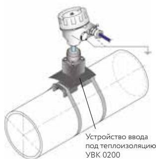
Измерение температуры трубы \varnothing \geq 57 мм
