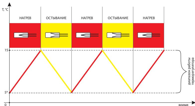
\* Секция нагревательная кабельная включается в сеть при положительной температуре окружающей среды, чтобы исключить возможность замерзания продукта в трубопроводе. Для предварительного прогрева пустого трубопровода необходимо включить нагревательную секцию в сеть на 5 минут перед пуском продукта (пустой трубопровод допускается прогревать при температуре не ниже -20 °C).
