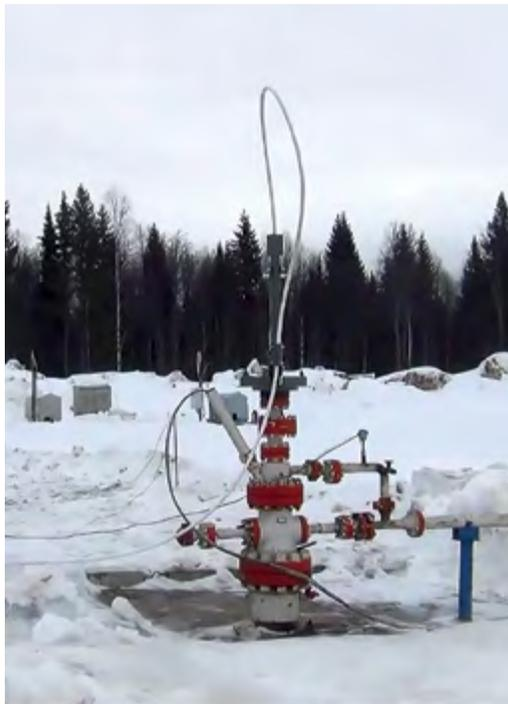
Рис.8. Выход нагревателя через лубрикативный узел
