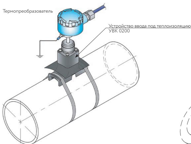
Монтаж термопреобразователя ТПУ 0304 на трубу с помощью устройства ввода под теплоизоляцию УВК.0200
