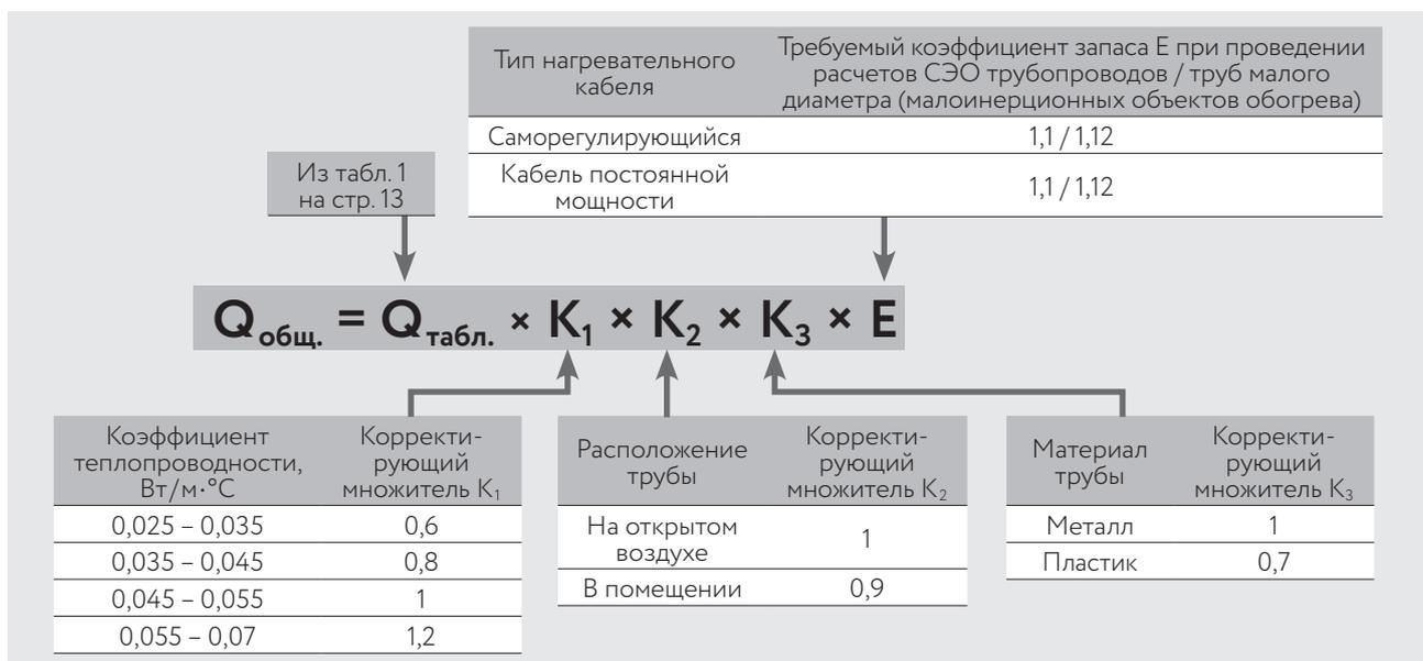
В результате проведения такого расчета получаем тепловые потери трубопровода при поддержании требуемой температуры для дальнейшего выбора марки нагревательного кабеля.
