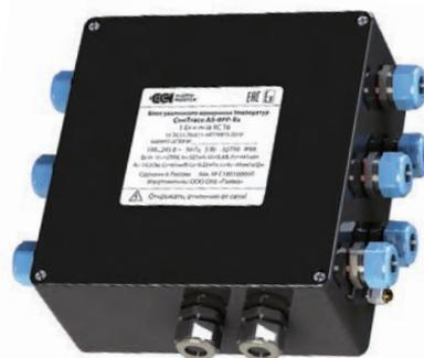
ConTrace AS-xxx-Ex в зависимости от типа исполнения может быть подключено до 8 термометров сопротивления. Поступающие с них данные передаются в шкаф управления посредством всего одного кабеля по стандарту RS-485. При этом на расстоянии в 1200 м может быть последовательно подключено до 16 блоков ConTrace AS-xxx-Ex. Это дает возможность отслеживать изменения температурных показателей системы электрообогрева в 128 точках одновременно.
