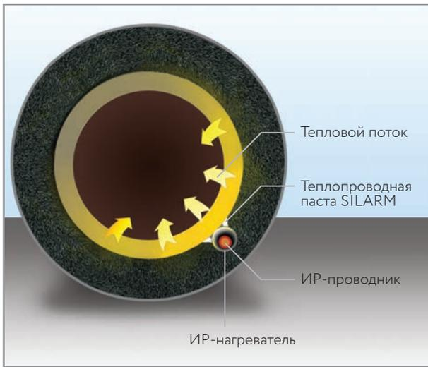
Безопасность системы обеспечивается поверхностным эффектом, за счет которого ток протекает по внутренней поверхности ИР-нагревателя. При этом на наружной поверхности потенциал равен нулю.
