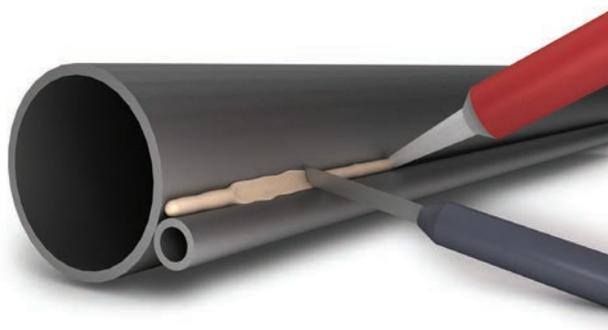
Паста SILARM наносится с помощью пистолета и шпателя в зазор между обогреваемой трубой и трубчатым нагревателем или кабелем для улучшения теплового контакта.
