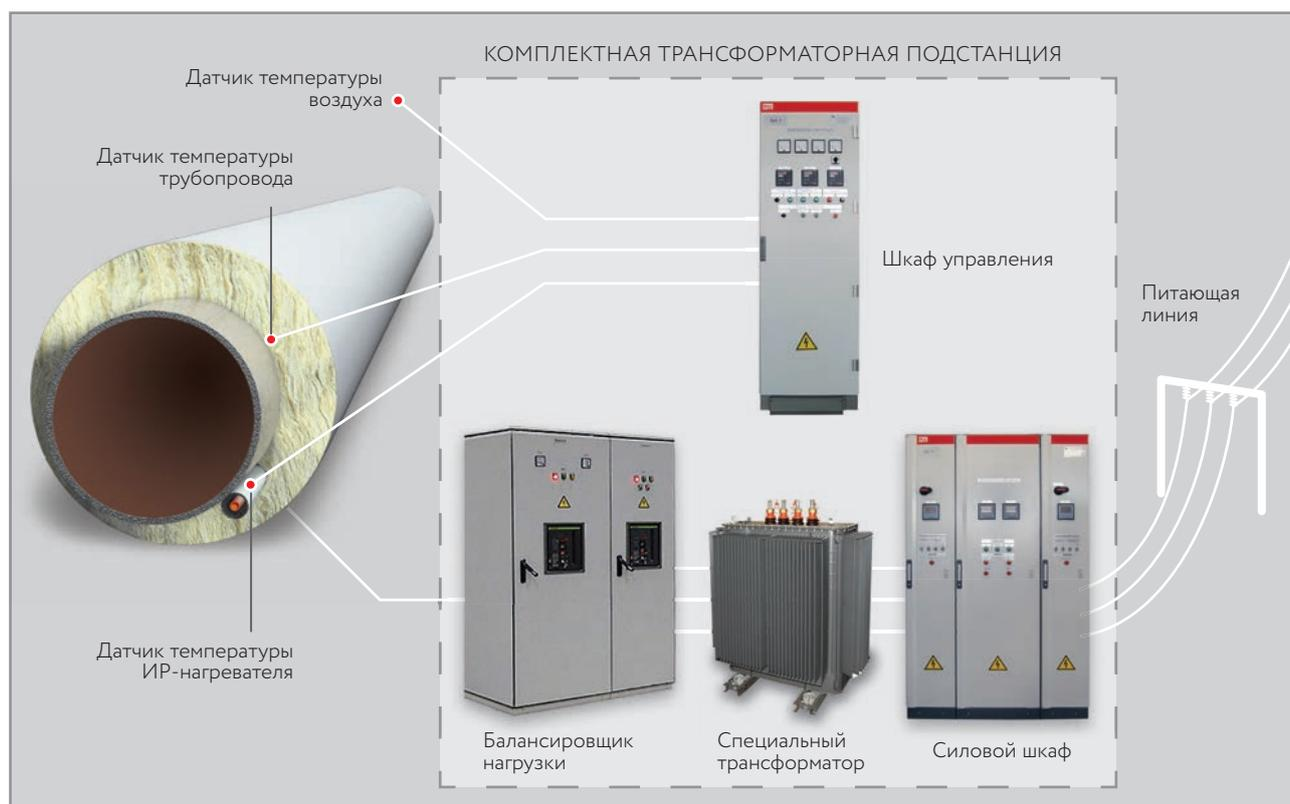
Для электроснабжения нагрузки применяются трансформаторно-конденсаторные преобразователи, которые состоят из балансировщика нагрузки и специального трансформатора. Это устройство позволяет подключать к трехфазной питающей сети мощную однофазную нагрузку (нагреватель скин-системы), при этом перекося токов в питающей сети отсутствуют.
