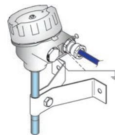
На примере изображен монтаж термопреобразователей с клеммной головкой 1Ex d [ia] IIC T1...T6X. Монтаж термопреобразователей с клеммной головкой 0Ex [ia] IIC T1...T6X полностью аналогичен.
