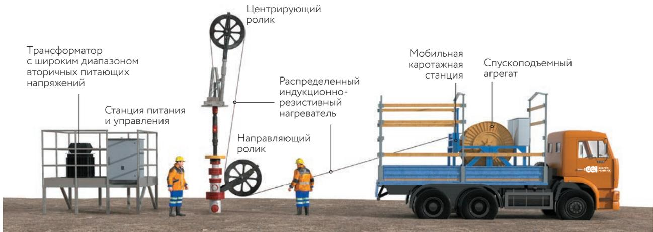
Схема размещения оборудования при монтаже нагревателя системы электрообогрева Stream Tracer™
