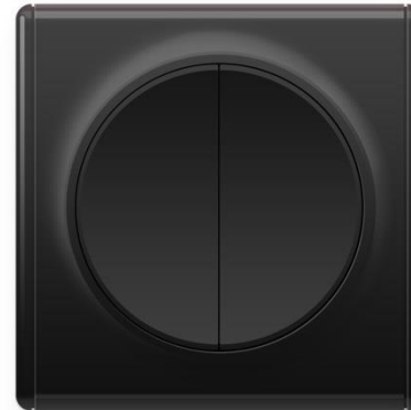
Переключатель двухклавишный Номинальный ток: 10АХ Напряжение: 250 В ~ IP20, пластик РС, монтаж скрытый
