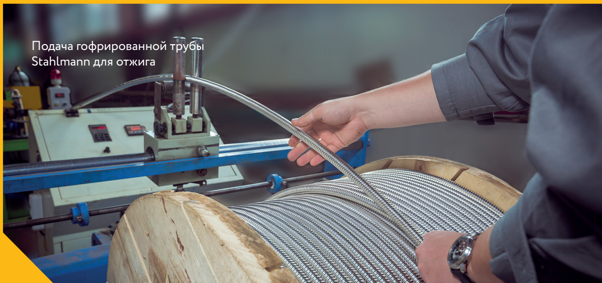
Линия охлаждения гофрированной трубы Stahlmann после отжига
