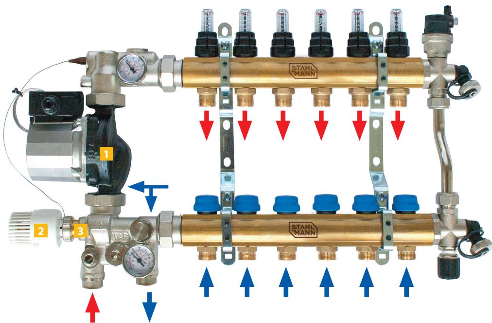
Циркуляционный насос 1 обеспечивает циркуляцию теплоносителя через петли теплого пола. При остывании теплоносителя ниже настроенной температуры термоголовки 2, смесительный клапан 3 открывается и обеспечивает подпитку вторичного контура теплоносителем из первичного контура с подмесом теплоносителя из подающего коллектора вторичного контура.
