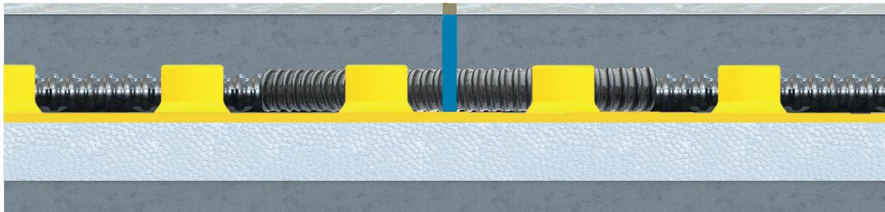
Деформационный шов представляет собой полосу из эластичного материала толщиной не менее 10 мм. В продаже можно найти готовые к монтажу варианты деформационных швов, но, как правило, они имеют высокую цену. Чаще всего в качестве деформационных швов используют две демпферные ленты Stahlmann, которые склеены друг с другом клейкими сторонами, но не по всей высоте - снизу оставляют около 10 мм, на которые этот демпферный шов kleится к основанию.
