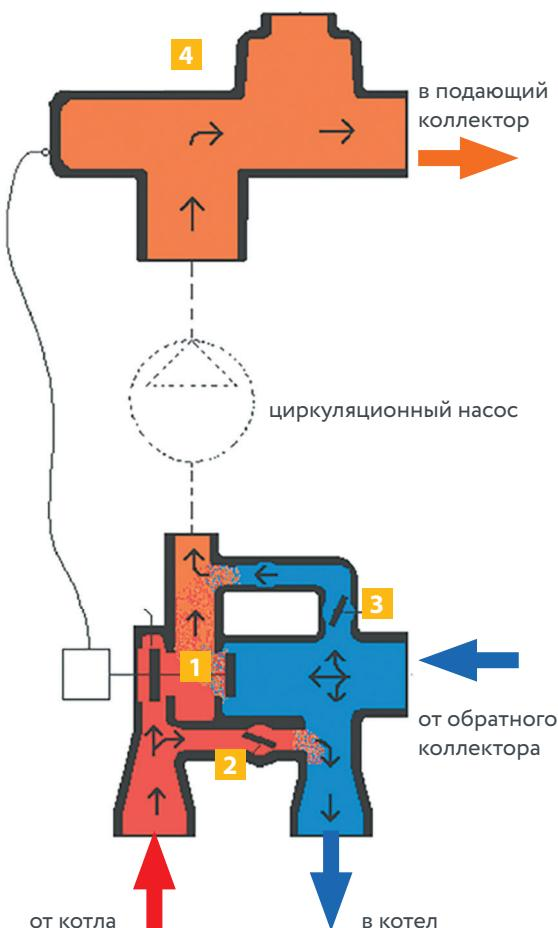
Смесительный узел Stahlmann состоит из двух частей – непосредственно насосно-смесительной части и байпасса с перепускным клапаном избыточного давления.
