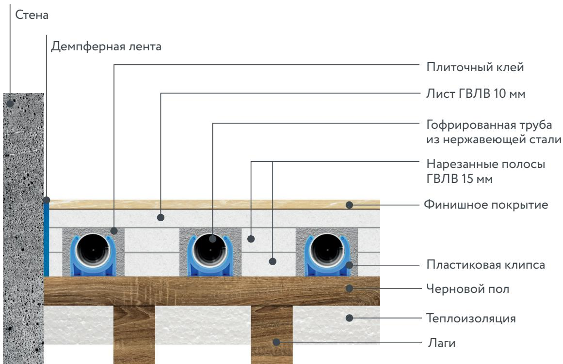
1. По всему периметру помещения, без пропусков, укладывается **демпферная лента**. Для повышения удобства и уменьшения времени монтажа демпферная лента Stahlmann имеет клеевой слой в виде полосы по центру одной из сторон ленты.
