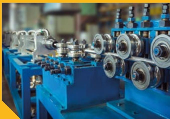
Линия охлаждения гофрированной трубы Stahlmann после отжига
