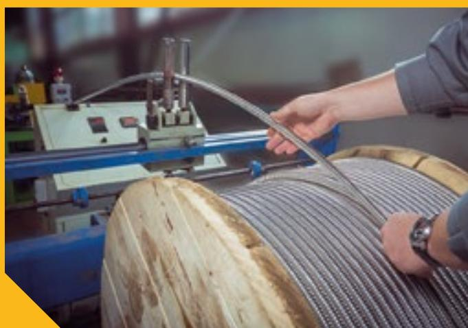
Подача гофрированной трубы Stahlmann для отжига
