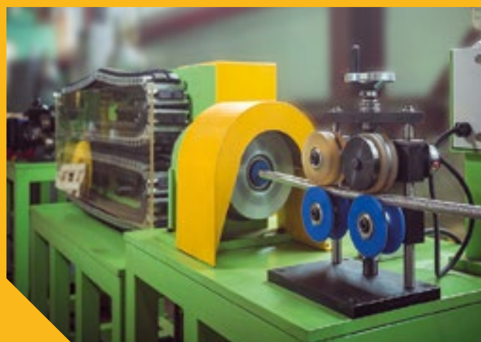
Процесс гофрирования трубы
