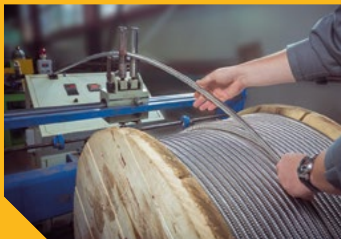
Подача гофрированной трубы Stahlmann для отжига
