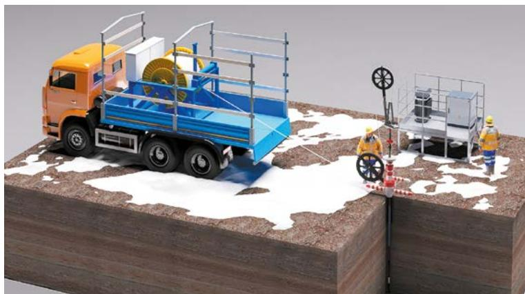
Для монтажа и обслуживания системы Stream Tracer™ используется мобильный комплекс на базе автомобиля повышенной проходимости и спуско-подъемного механизма. Сама система состоит из нагревателя для обогрева скважин, станции управления, силового трансформатора и устьевого шлюза.
