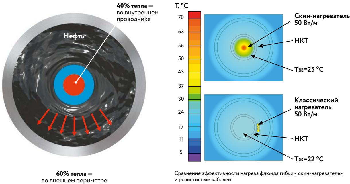
В отличие от классических способов электрообогрева гибкий скин-нагреватель размещается внутри НКТ, в непосредственном контакте с нефтяной жидкостью. Это обеспечивает большую эффективность обогрева по сравнению с другими решениями.
