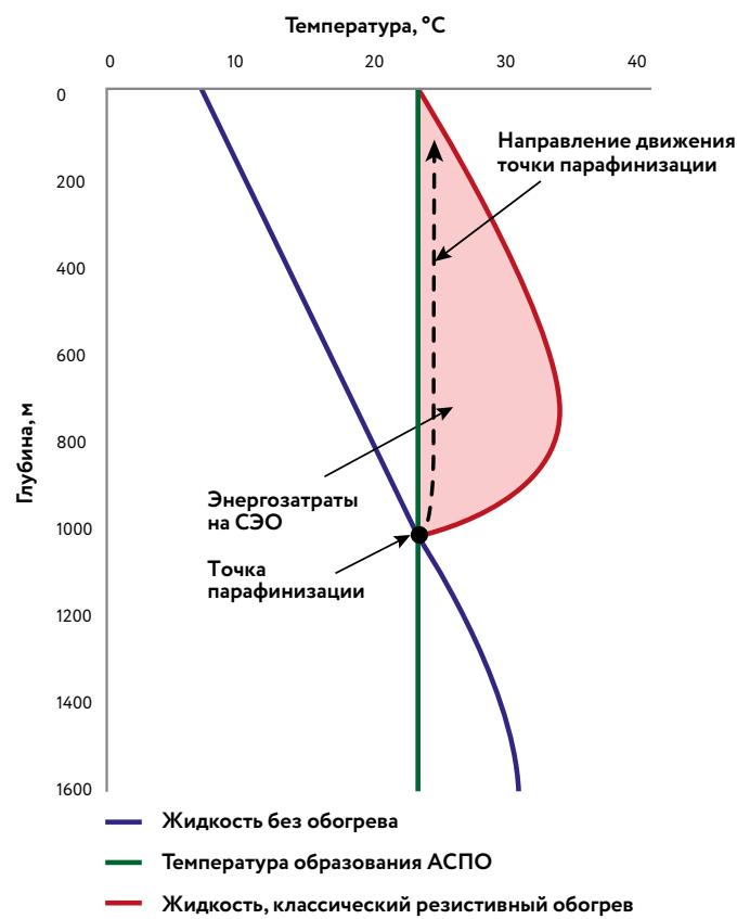
Внешние граничные условия, определяющие теплопотери НКТ, переменны по глубине скважины – геотерма грунта имеет наклон около 20 – 30 °C на километр. Соответственно, обогрев скважины нагревательным кабелем с линейной мощностью, постоянной по всей длине, приводит к избыточному энергопотреблению системы электрообогрева.
